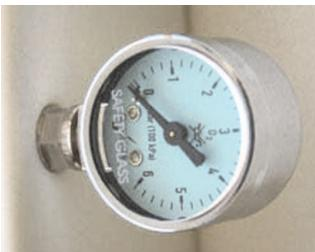
Nur der an diesem Manometer angezeigte Druck ist für Einstellung relevant.
