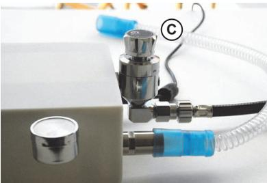
Drehen Sie jetzt im Uhrzeigersinn am Einstellrad (C) des Druckminderers, bis Sie den gewünschten Druck am Manometer erreicht haben.
