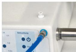
Achten Sie auf die farbliche Zuordnung von Buchse und Schlauch. In der roten Schlauchleitung befindet sich ein Schutzfilter für das Gerät.
