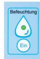
Der minimale Befeuchterflow in der Aufwärmphase beträgt 23 l/min +/- 3 l. Bei eingeschaltetem Befeuchterflow und angeschlossenem Patienten kann durch Drücken der Taste Info der aktuelle Patientendruck abgelesen werden.
