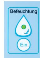
Diese Funktion dient dem ordentlichen Vorheizen des Befeuchters bis zum Erreichen der Betriebstemperatur. Diese sollte für die Wassertemperatur mindestens 37°C betragen.
