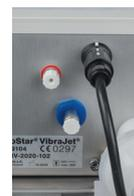
Verbinden Sie die Schläuche zum Anwendungsteil mit den dazugehörigen Buchsen. Achten Sie auf die farbliche Zuordnung von Buchse und Schlauch. Anschluss der Druckleitung – blau markiert.
