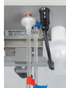
Verbinden Sie den beheizbaren Schlauch des Befeuchters mit dem seitlichen Anschluss der Mischkammer am Patientenanwendungsteil. Achten Sie darauf, dass Jet-Adapter und Mischkammer miteinander verbunden sind.
