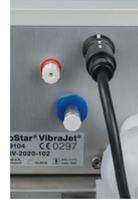
Verbinden Sie die Schläuche zum Anwendungsteil mit den dazugehörigen Buchsen. Achten Sie auf die farbliche Zuordnung von Buchse und Schlauch. Anschluss der Druckleitung – blau markiert.
