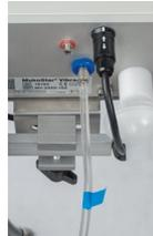
In der rot markierten Schlauchleitung befindet sich ein Schutzfilter für das Gerät.
