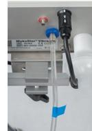
In der rot markierten Schlauchleitung befindet sich ein Schutzfilter für das Gerät.
